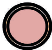
Cable de robótica estándar 1 x 25 mm 2 Frecuencia 50 Hz
