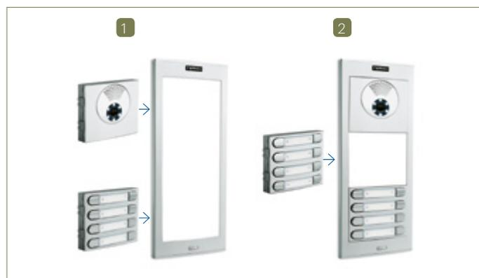
Sistema de montaje y clipado de módulos a marcos sencillo y eficaz. Los módulos encajan perfectamente en el perfil. Unas juntas entre módulos evitan la entrada de agua y suciedad. Una vez montada la placa, se conectan entre sí los distintos módulos.
