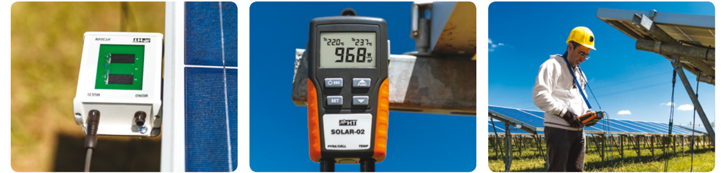
Sensor de Irradiación HT304N. Unidad remota Solar02. Sólo es necesario una persona para realizar todas las mediciones.
